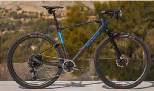
Techniquement, il s'agit d'un système Mahle X20 composé d'une batterie de 350 Wh dans le tube diagonal et d'un petit moteur de 23 Nm logé dans la route arrière, soit l'équivalent de 55 Nm s'il était logé en central. Cette configuration présentant une bonne répartition des masses entre l'avant (batterie) et l'arrière (moteur) lui confère une très bonne stabilité. La vocation de ce vélo est clairement sportive, comme à l'habitude chez Mondraker, mais tout en restant confortable.
